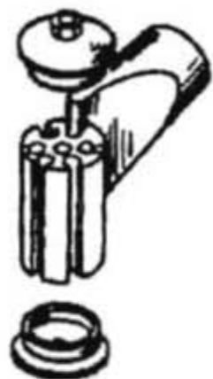
Рис. 3.7. Комбинированное узловое сопряжение стержневых структурных плит «Триодетик»
